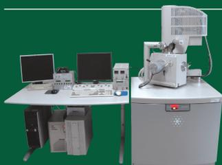
試料作製装置(FIB-SEM)
